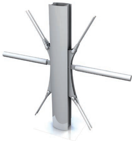
Vista 3D e dettagli in fase di cantiere di una megacolonna.
