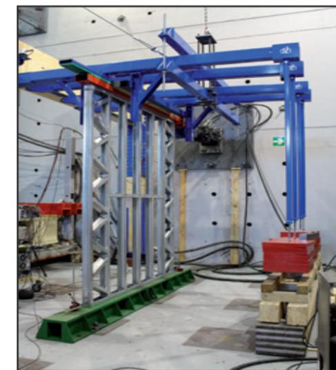
La novità e la complessità d'impiego dei profili metallici sottili formati a freddo in ambito strutturale è regolata da una normativa (Eurocodice 3-1-3) che sottolinea e ribadisce più volte la necessità di ricorrere a prove sperimentali, mediante il "design assisted by testing".
