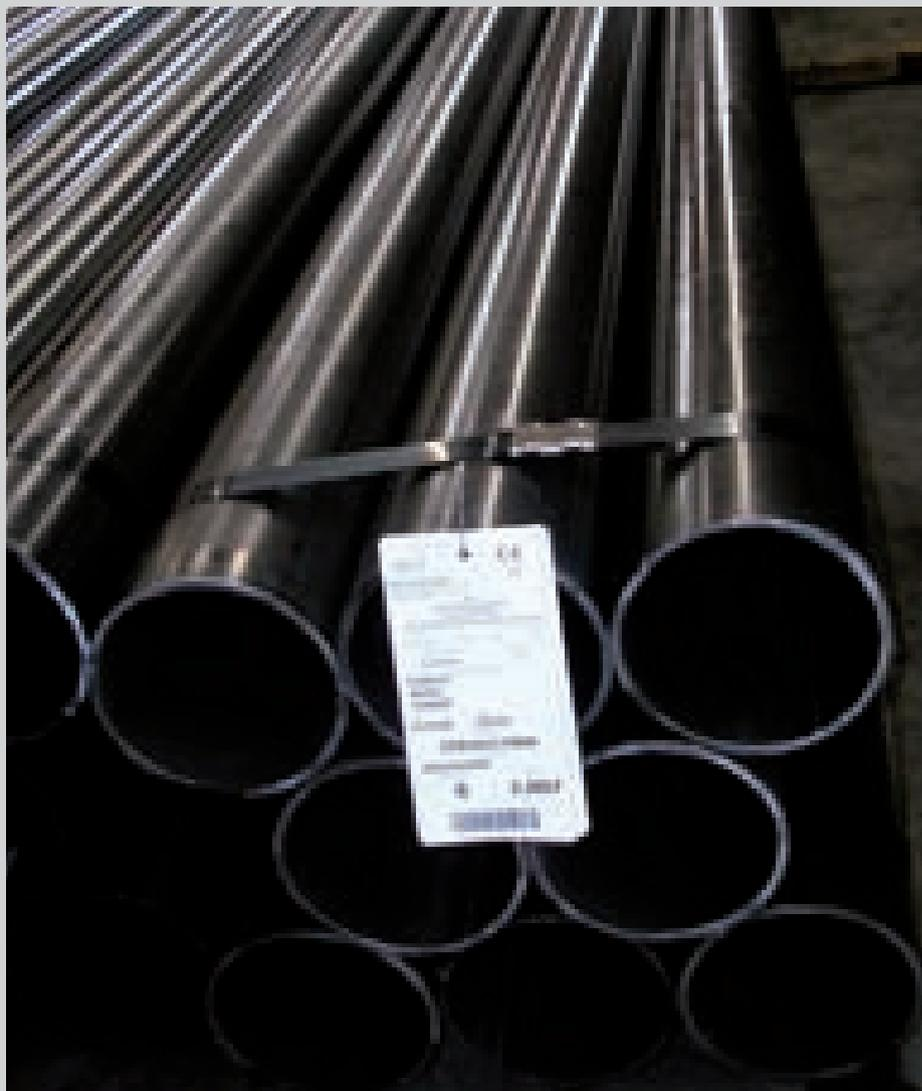
ed i profili cavi formati a freddo con trattamento termico successivo (normalizzati, per ottenere condizioni metallurgiche equivalenti a quelle ottenute nel prodotto formato a caldo).
