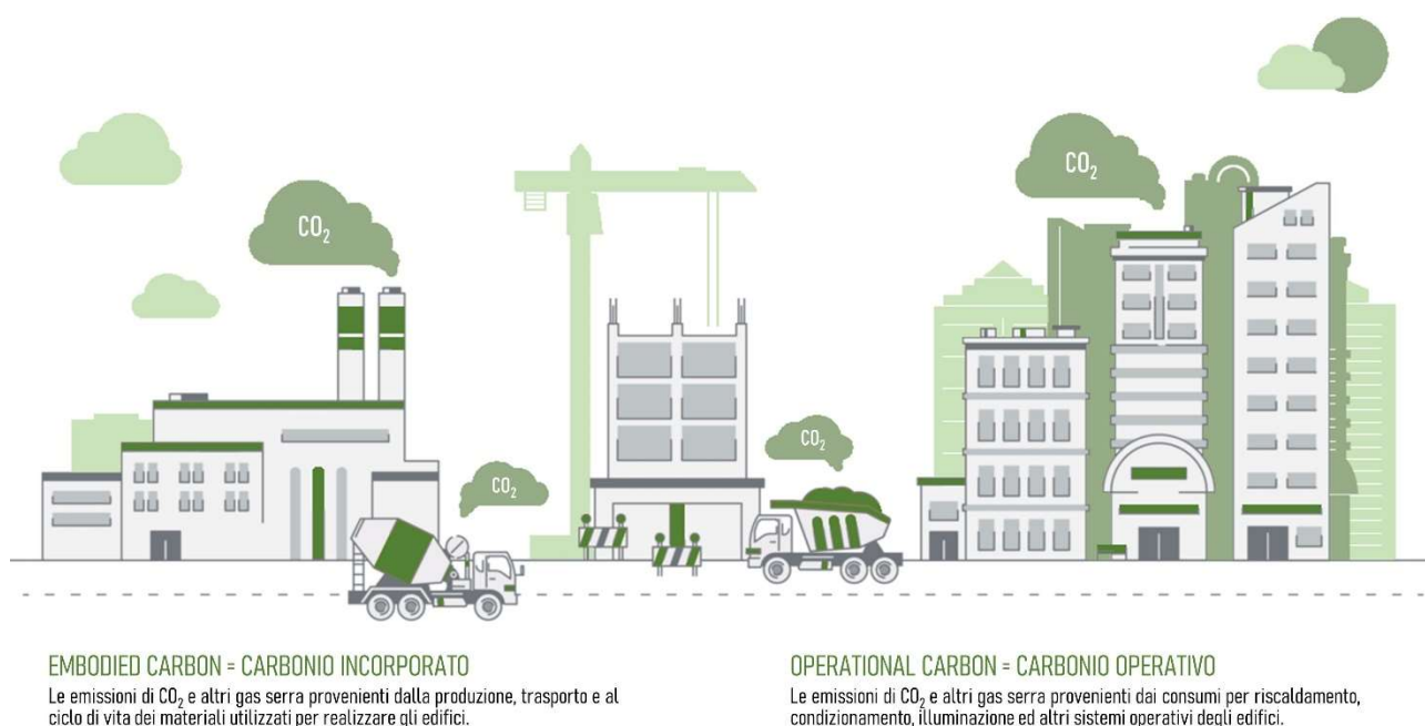
Figura 4. Illustrazione di operational ed embodied carbon nel settore delle costruzioni. (rielaborazione autori)
