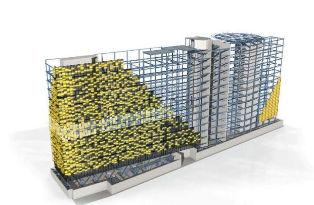
Figura 27. Vista tridimensionale di strutture in carpenteria metallica pesante e rivestimenti di facciata a secco (a sinistra, PICHLER projects Srl) e sezione prospettica di un edificio con tecnologia S/R in Light Steel Frame (a destra, Manni Green Tech Srl)
