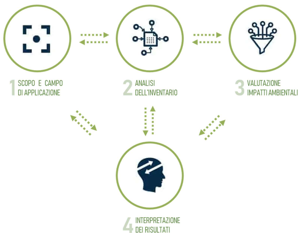
Figura 20. Illustrazione delle quattro fasi che compongono un'analisi LCA. (elaborazione autori)
