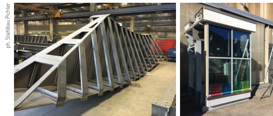
Elementi prefabbricati in officina e mock up facciate
