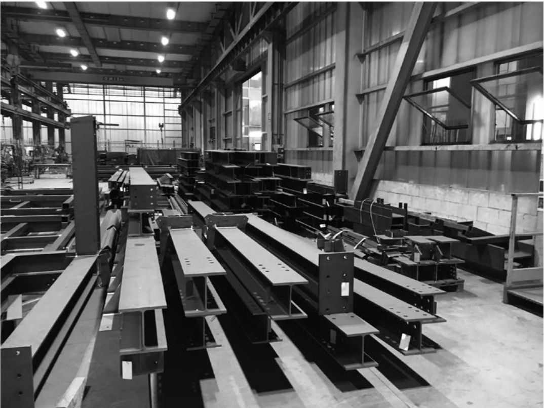
Pre-assemblaggio delle travi in officina
