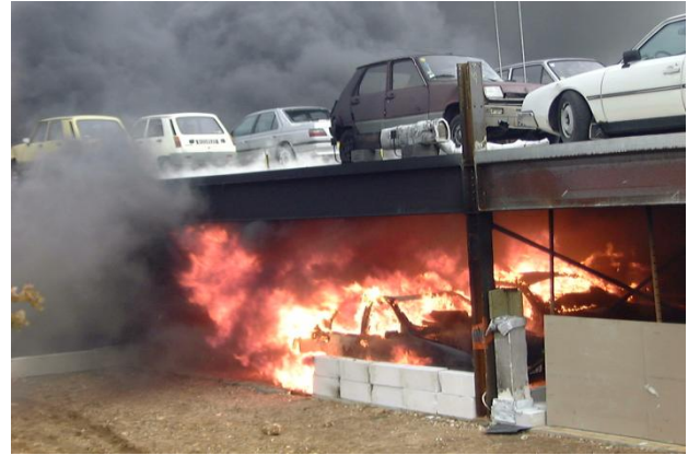
Figura 4 - Prove sperimentali di incendio in scala reale in un edificio adibito ad autorimessa di tipo aperto (CTICM, 2001).
