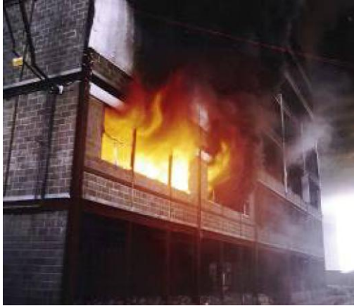
Figura 3 - Esempio di incendio pienamente sviluppato, dovuto alla combustione di materiali presenti dentro un edificio adibito ad ufficio (BRE, 2004).
